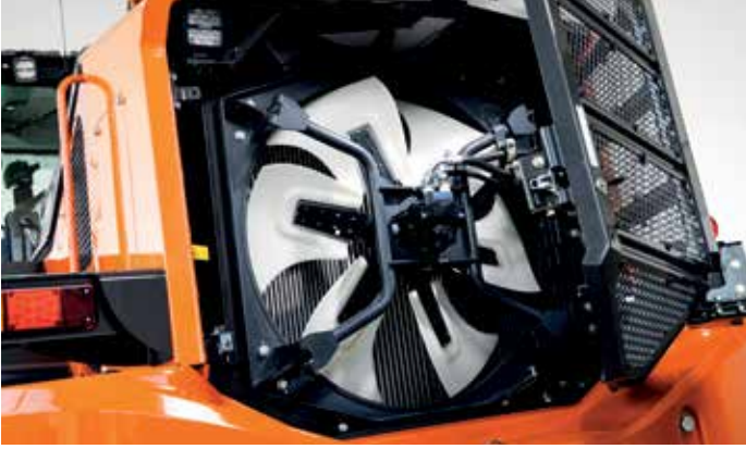
Akıllı fan çalışma sistemi radyatörlerin tıkanmasını önler.
