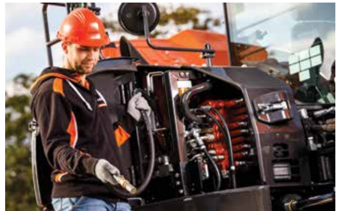
Ekskavatöre elektrikli pompa kullanılarak yakıt ikmali yapılabilir.
