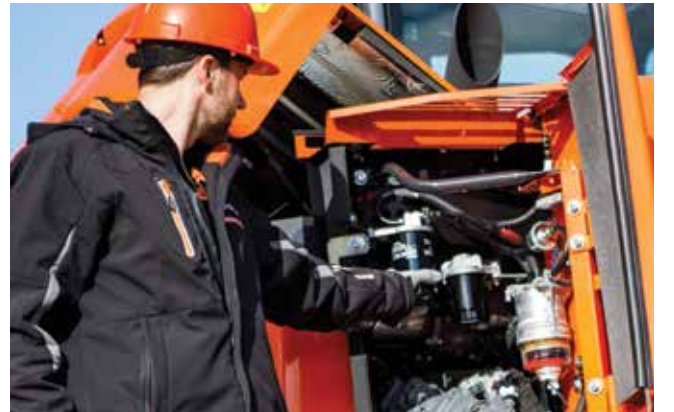
Günlük denetim noktaları kolaylık sağlamak için gruplandırılmıştır.
