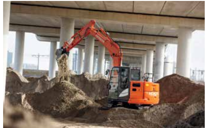
Kısa dönüş yarıçapı dar alanlarda çalışmak için idealdir.
